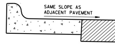
REVERSE SLOPE GUTTER
