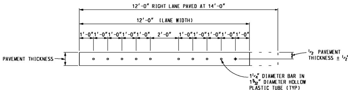
**DEFORMED BAR SPACING
