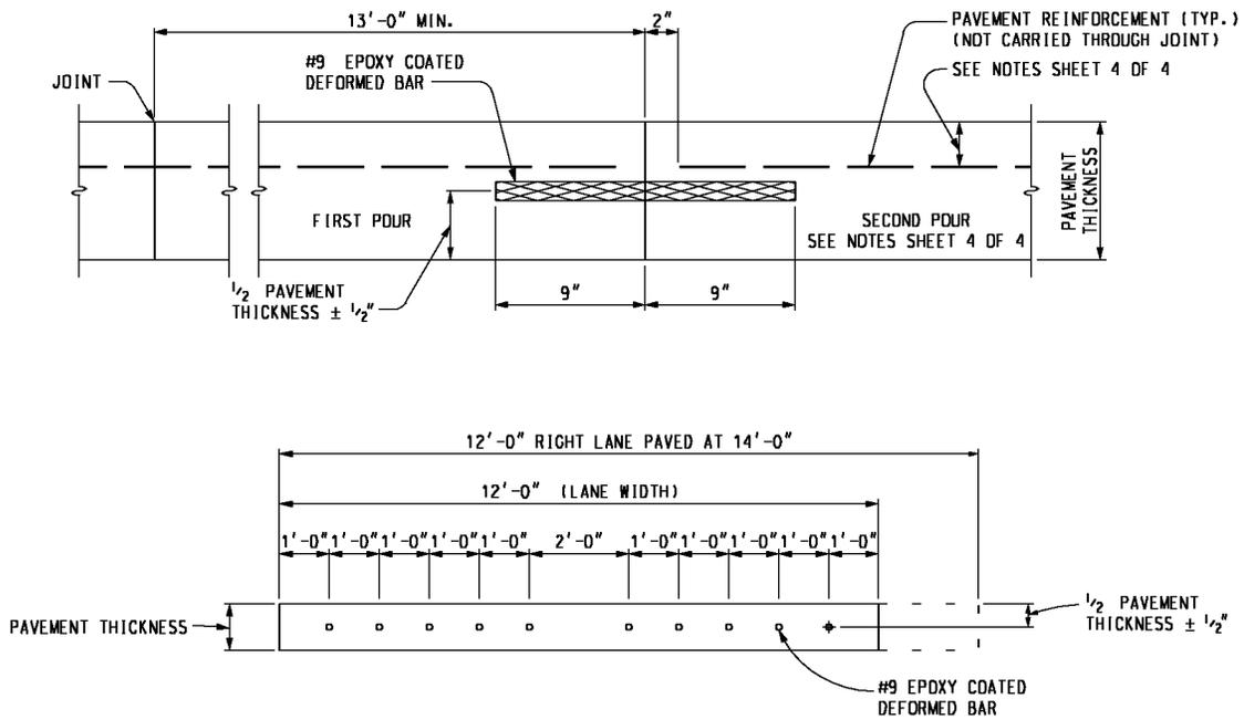
**DEFORMED BAR SPACING**
