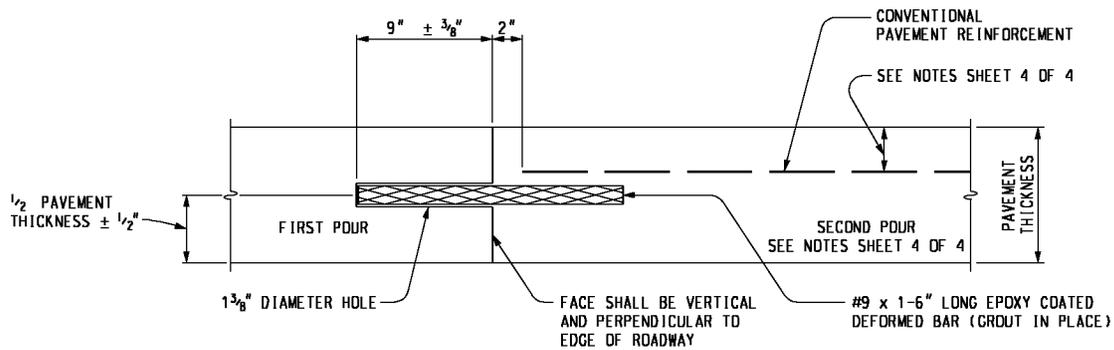
**DEFORMED BAR SPACING**
