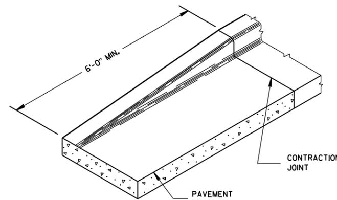
END SECTION CURB & GUTTER
