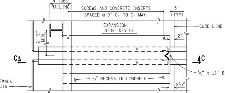
PLAN AT 4 TUBE (PEDESTRAIN) STEEL RAILING
