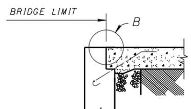
**APPROACH SLAB SUPPORTED ON ABUTMENT BACKWALL**
