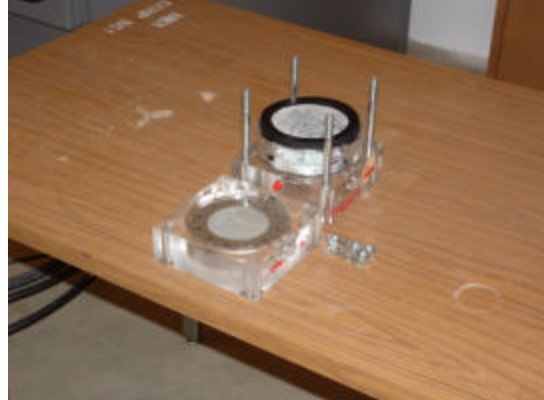
(d) Rubber gasket at the top of specimen
