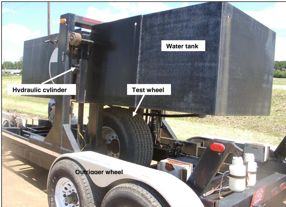
Fig. A10. RWD test apparatus.
