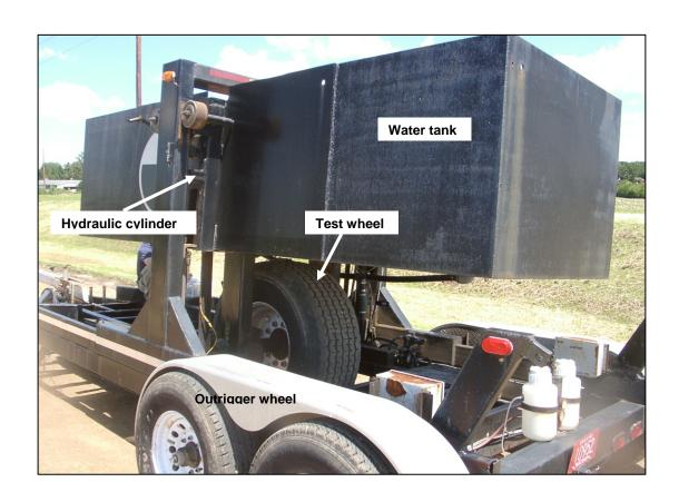
Fig. A10. RWD test apparatus.
